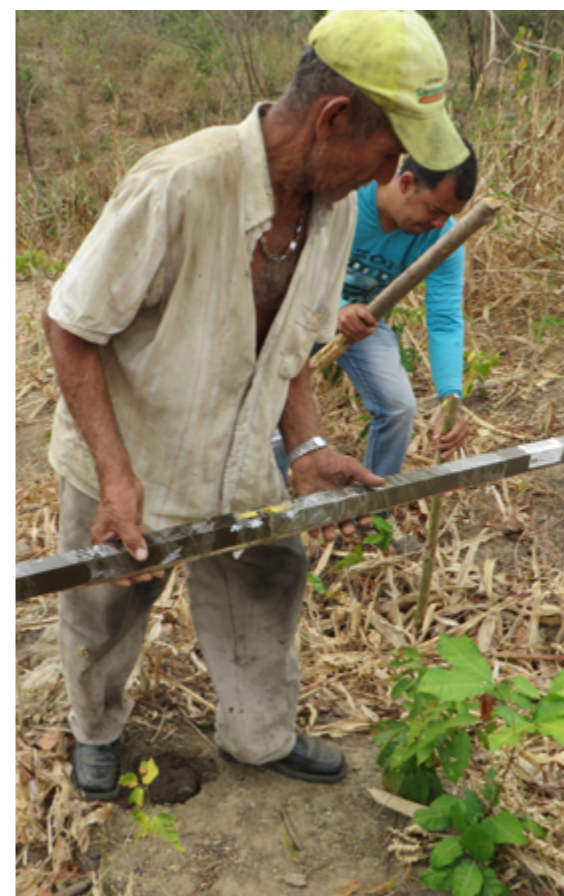
Figuras 10 y 11. Empieza el trabajo para trazar curvas a nivel, Hibácharo Piojó, departamento del Atlántico. Fuente: Jesús Castillo, Álvaro Ceballos Freire y Jorge Baguí
